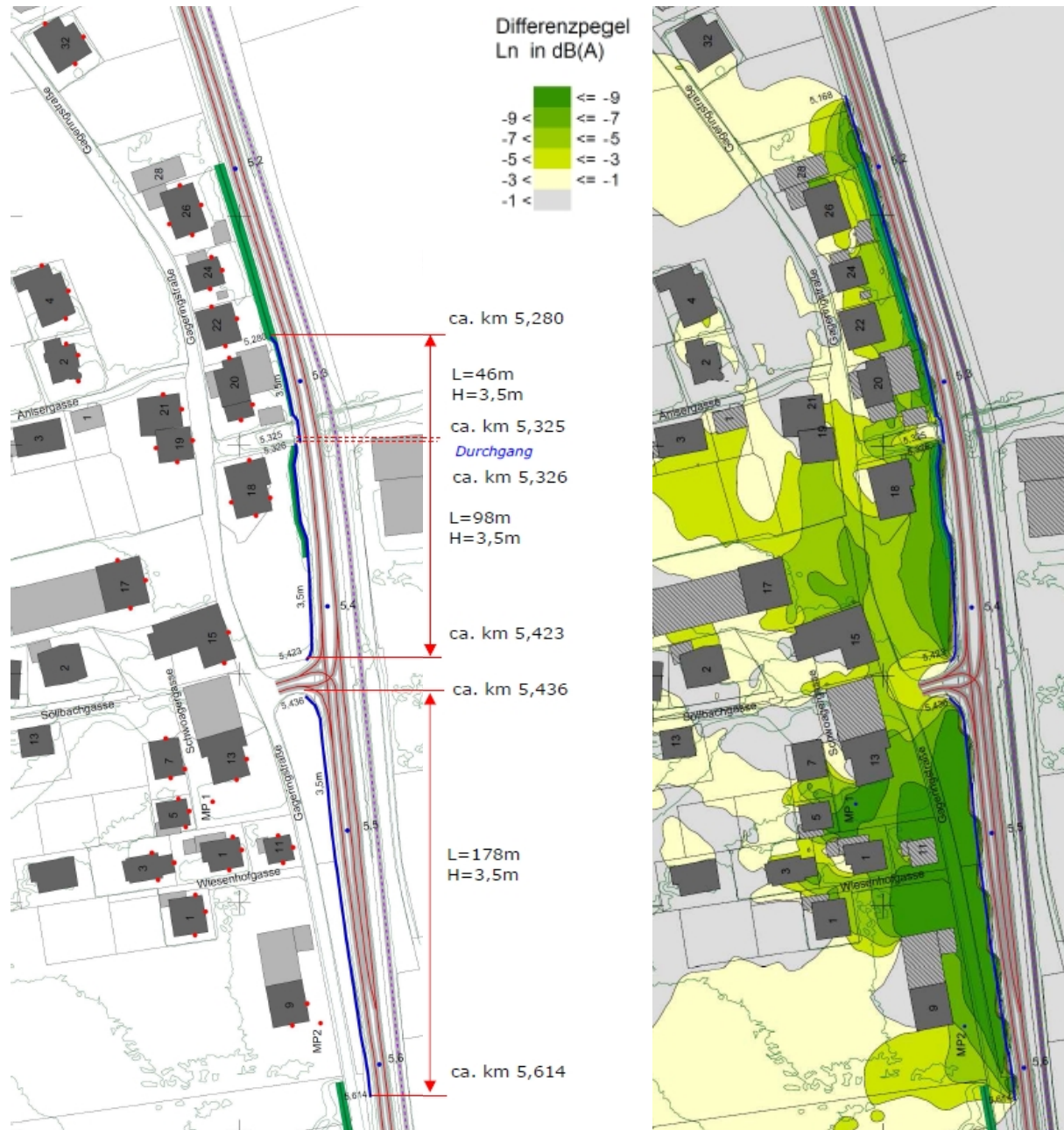
Bild 11: Übersichtslageplan und Differenzlärmmarte Lärmschutz Gagering, km 5,1 bis km 5,6
